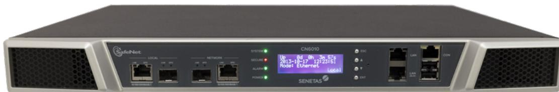
図4 - CN6010高速ネットワーク暗号装置
